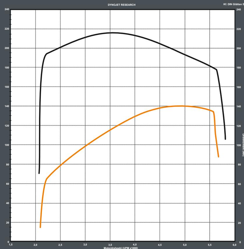
**TORXSTER 2300, Max. Power = 140 PS (Motorenleistung)**
