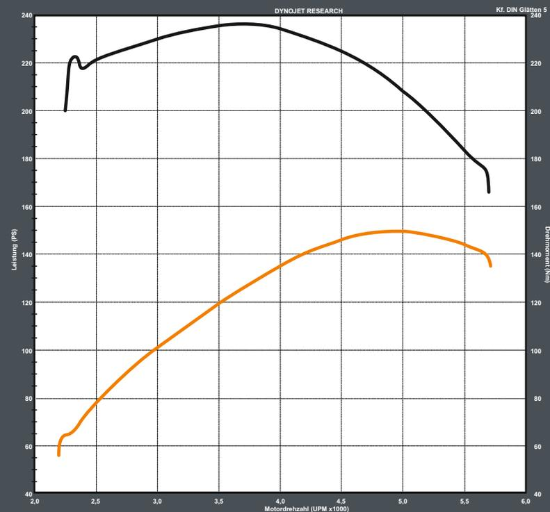
■ HyperTORXSTER 2300, Max. Power = 147,50 PS (Motorleistung) / 5000 rpm
